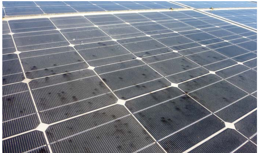
Bild 3: Degradation von PV-Glas
