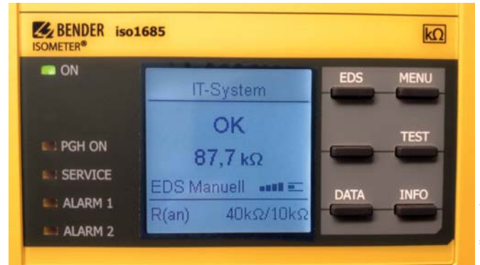
Bild 6: Display eines IMD mit aktuellem mit Isolationswert
